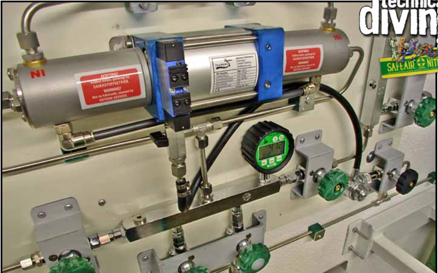
De TecServe 220-2 boosterpomp is ontworpen voor het pompen van helium, zuurstof en lucht tot 300 bar. Het slagvolume is ca. 26 cm 3 . De aanvoerdruk is min. 15 bar. Aandrijving op lucht 2-10bar.
